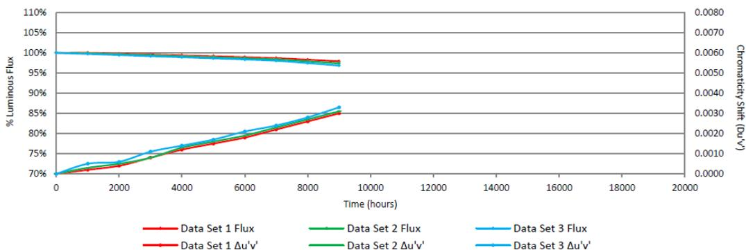
1800K,  $I_f=250\text{mA}$ , Data Set 1:  $T_c=55^\circ\text{C}$ ; Data Set 2:  $T_c=85^\circ\text{C}$ ; Data Set:  $T_c=105^\circ\text{C}$
